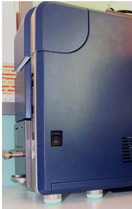
▲ Sensible elektronische Geräte werden mit Sylodamp®-Lagern geschützt.
