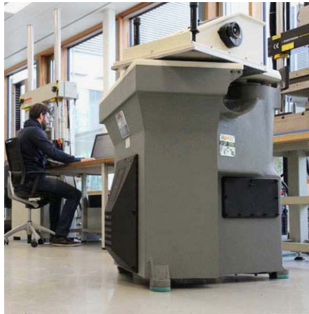
▲ Schwingungsentkopplung einer Stanze für den ungestörten Betrieb
