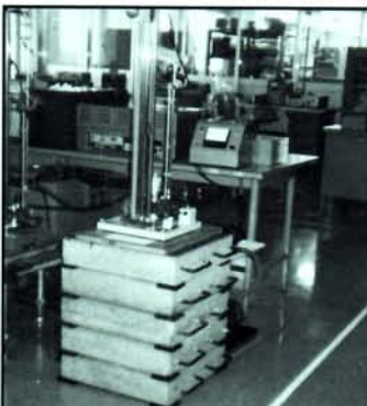
△ Passive Isolierung in einem meteorologischen Labor.
