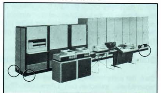
△ Isolierung von Computern und elektronischen Kabinen (passive Isolierung).
