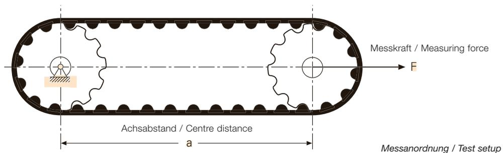
Messkräfte für Längenmessung / Measuring forces for length measurements
