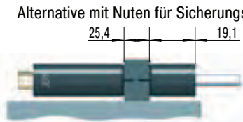
Einbaumontage für VC25...F mit Klemmblock KB... (23,8 mm für glatten Körper)
